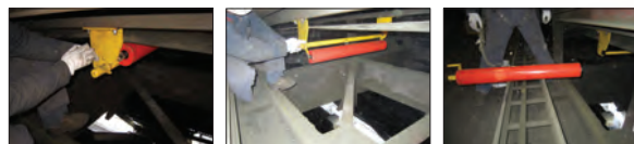
Fácil de extraer desde cualquiera de los extremos del transportador.
